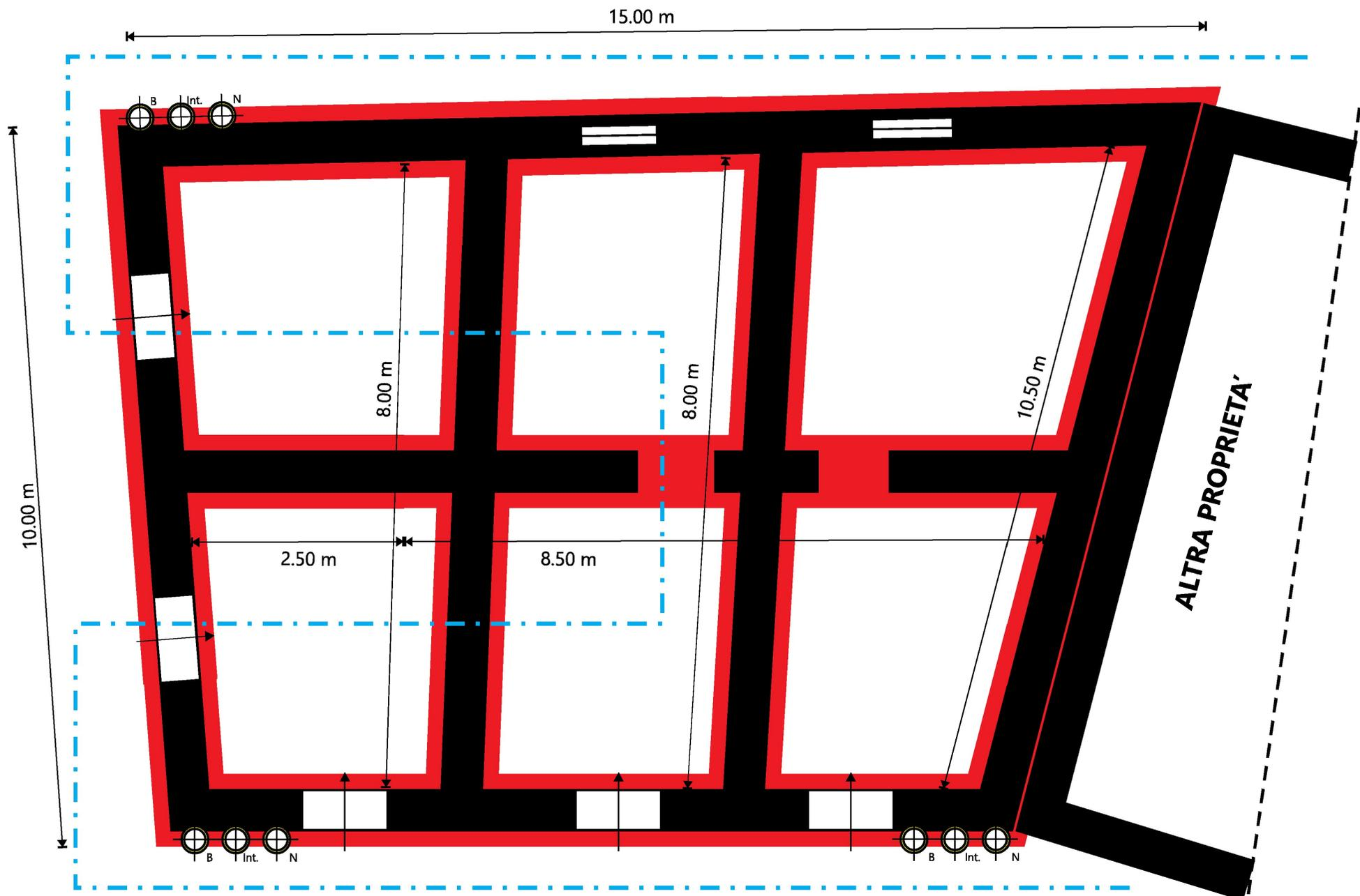
**Opere di Consolidamento e Stabilizzazione del Terreno a mezzo iniezione di resine espandenti e micro pali.**
